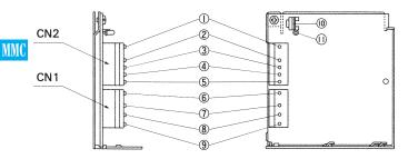
⑦AC(N) **1V1 Output** 2G1(V1) GND **3V2 Output**
