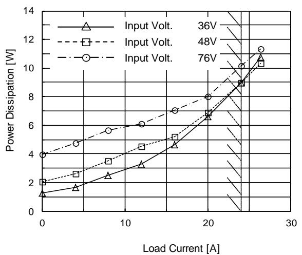
(d) Power Dissipation( by Load Current )
