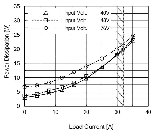
(d) Power Dissipation( by Load Current )
