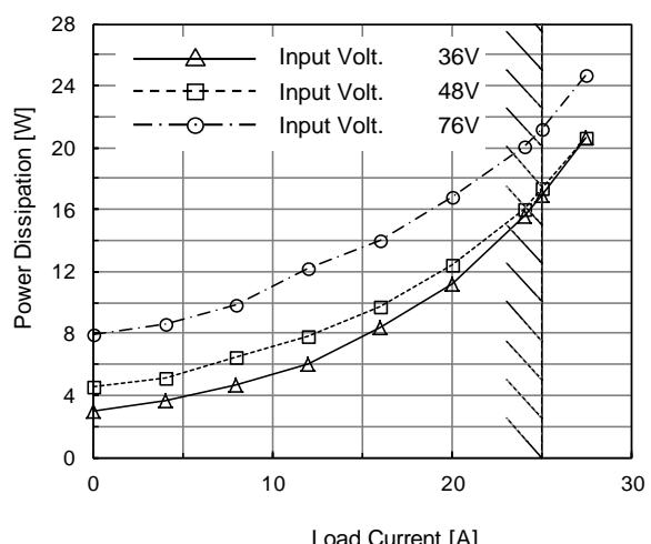
(d) Power Dissipation( by Load Current )
