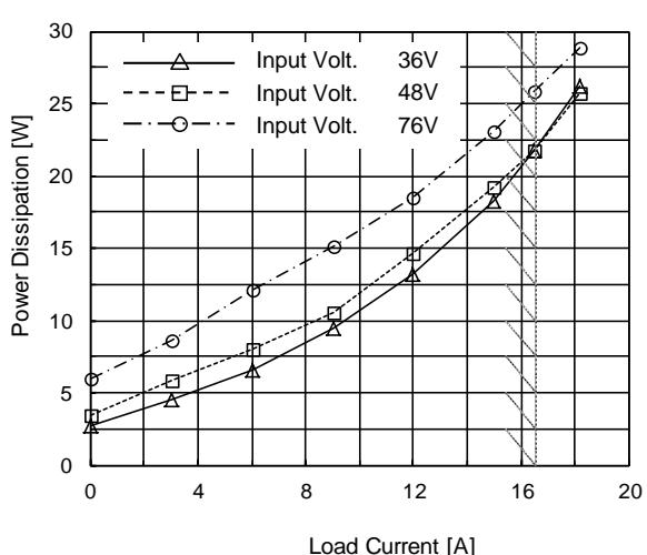
(d) Power Dissipation( by Load Current )
