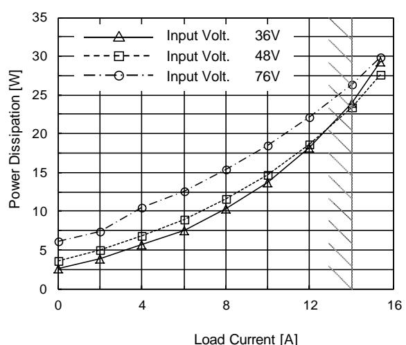
(d) Power Dissipation( by Load Current )
