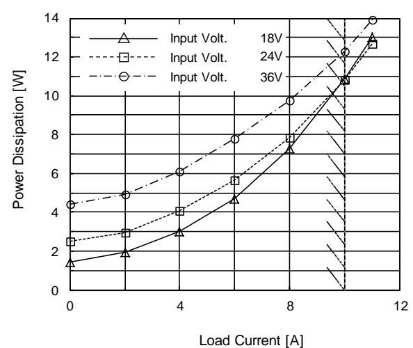
(d) Power Dissipation( by Load Current )
