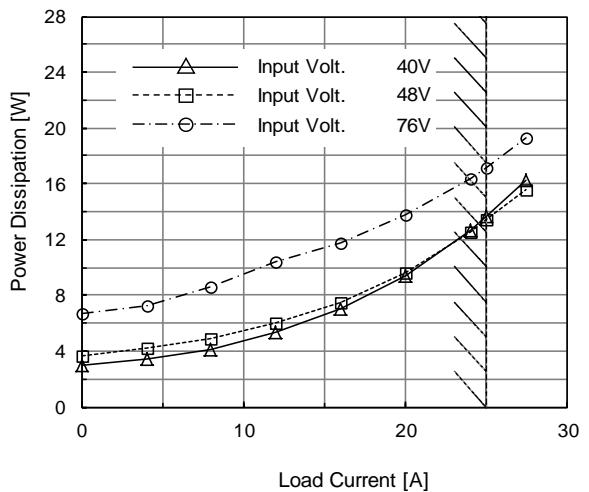
(d) Power Dissipation( by Load Current )
