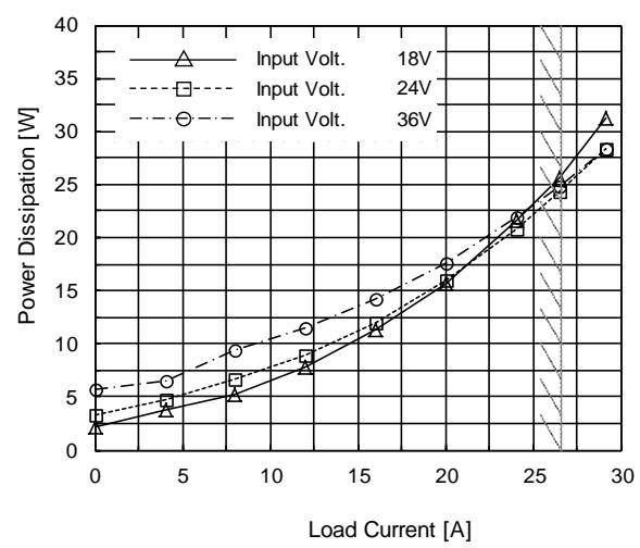
(d) Power Dissipation( by Load Current )
