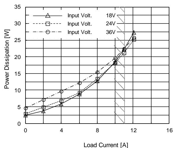
(d) Power Dissipation( by Load Current )
