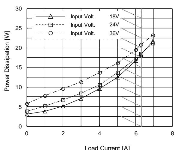
(d) Power Dissipation( by Load Current )
