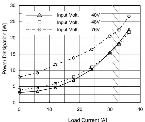
(d) Power Dissipation( by Load Current )
