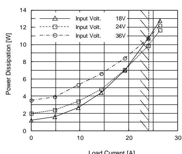
(d) Power Dissipation( by Load Current )
