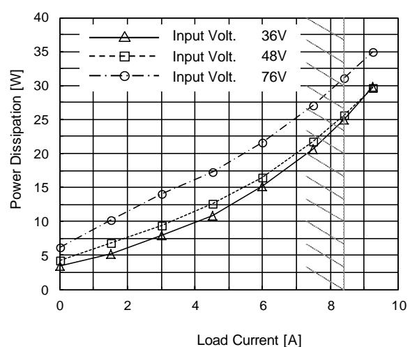
(d) Power Dissipation( by Load Current )
